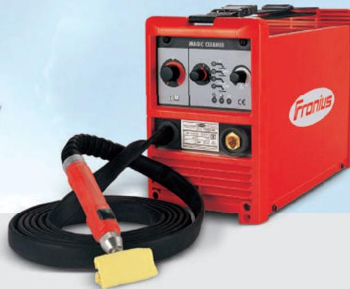
/ Le MagicCleaner vous permet de procéder au décapage électrochimique, de façon simple et rapide, des tôles et tubes en inox Petit, léger (5 kg) et compact, cet appareil est parfaitement adapté à une utilisation sur les chantiers et dans tous les ateliers. Avec ses courbes de courant régulées par micro-processeur, il nettoie proprement et rapidement les soudures TIG. Une fonction permet de garantir aux surfaces un aspect poli après décapage.
