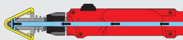
/ Commande pour activer l'électrolyte intégrée à la poignée, dosage précis grâce à l'arrivée du fluide manuelle ou automatique.
