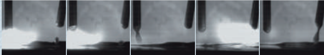
Transfert de matière en soudage «TimeTwin Digital», avec arc pulsé décalé en phase de 180°.
