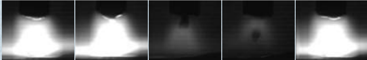
Vue longitudinale d'un transfert de matière en soudage à fil plat AISi5 avec arc pulsé.
