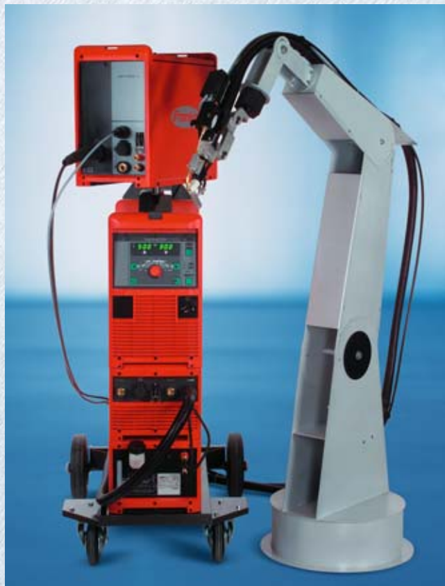
MagicWave 5000 et torche de soudage par robot Robacta TTW 4500 avec unité d'entraînement fil froid Robacta KD-Drive
